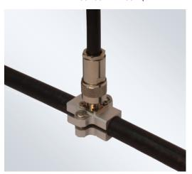
Делитель выполнен в виде навесного блока размером 35×25×20 мм, устанавливаемого в отверстие кабеле. Крепление делителя осуществляется кабелю непосредственно К ДВУМЯ винтами, стягивающими основную и прижимную планки делителя. По всему периметру прилегания к кабелю делитель имеет уплотняющее покрытие, обеспечивающее полную соединения ДЛЯ предотвращения герметизацию попадания влаги во внутренне пространство кабеля. Для подключения вторичных кабелей делитель снабжен разъемом типа N-female.
